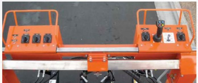
izquierdo y derecho de caja esparcidora, desplazamiento lateral de caja esparcidora, desviador izquierda/derecha, levante arriba/abajo de caja, el control de flujo de agua, control de flujo de aditivo y flujo completo de aditivo (momentáneo) para trabajo de mano.
