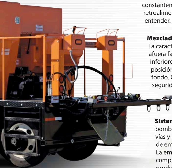
**Sistema EMCAD** – Permite una calibración simple con ajustes simples ya que el diseño de mezcla se mantiene automáticamente mientras que los volúmenes de producción cambian; diagnósticos a bordo monitorean constantemente el equipo y proporcionan una retroalimentación del desempeño, fácil de entender.
