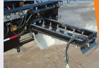
**Sistema de Emulsión Asfáltica** – Una bomba Tri-Rotor, una válvula de tres vías y un filtro en línea permiten la carga de emulsión asfáltica sin problemas. La emulsión se puede cargar a flujo completo sin afectar los ajustes de producción.
